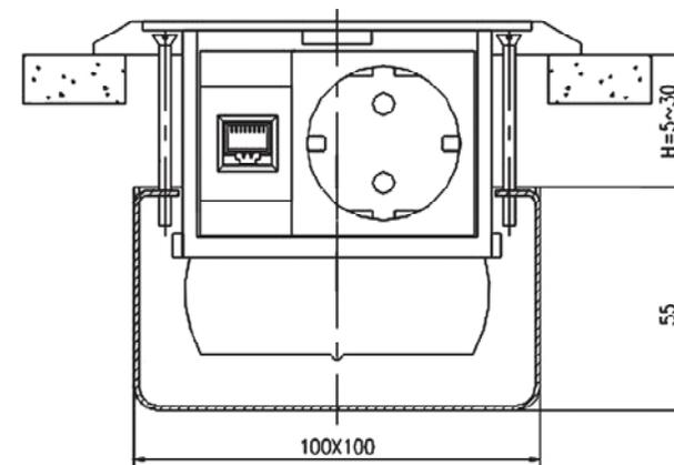
По периметру коробки расположены выбиваемые кабельные вводы. Размер вводов D 22 мм/D 27 мм. Монтаж люка осуществляется в фальшпол или под заливку в бетонные полы. При установки в фальшпол толщина покрытия Н 5-30 мм
